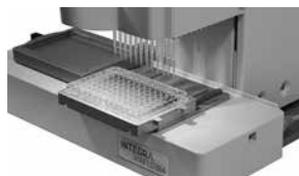
le fossé entre les pipettes manuelles traditionnelles et les systèmes automatisés, permettant un pipetage 96 canaux précis et reproductible. VIAFLO 384 est un système plus avancé, fonctionnant aussi bien avec des têtes de pipetage 96 canaux que 384 canaux pour un maximum de productivité. Il offre la même surface au sol et le même fonctionnement intuitif que VIAFLO 96.
